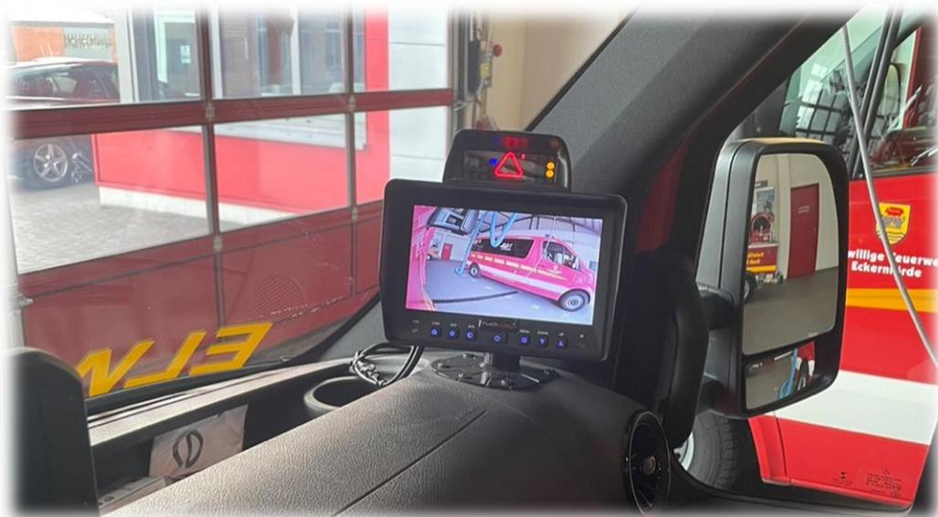
Abbiegeassistent - Einbau im Einsatzleitwagen 1-1<sup>2</sup>
