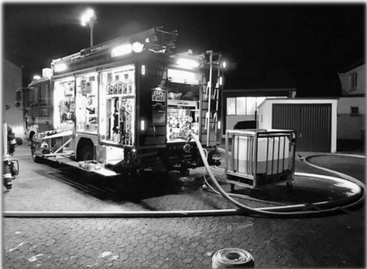
Schaummitteleinsatz über das Hilfeleistungslöschgruppenfahrzeug mit Einspeisung aus dem Rollwagen 600 l Schaummittel <sup>8</sup>
