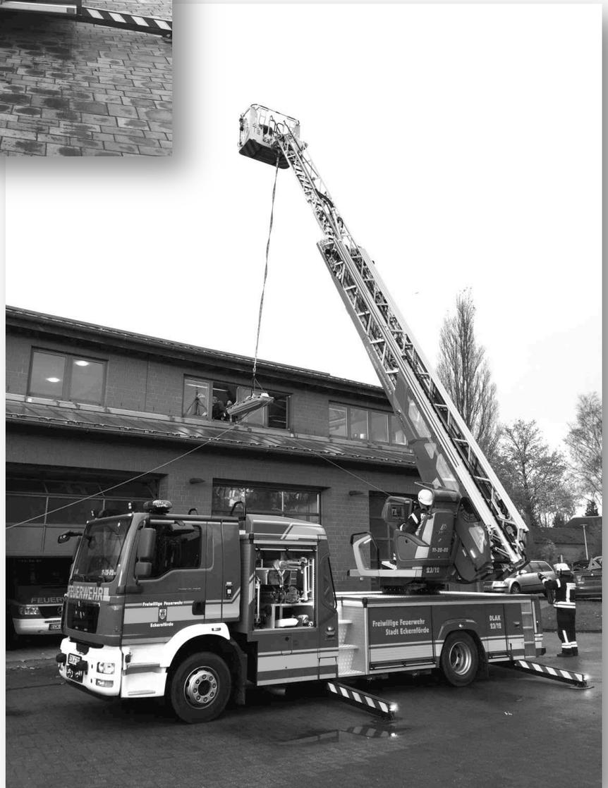
Einsatz mit dem Sicherungssystem Saefly-Peak an der Feuerwache<sup>2</sup>
