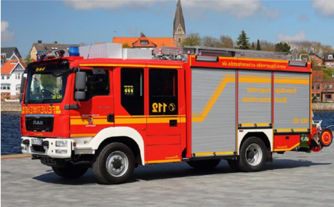
Bezeichnung: Hilfeleistungslöschgruppenfahrzeug (HLF 20)
